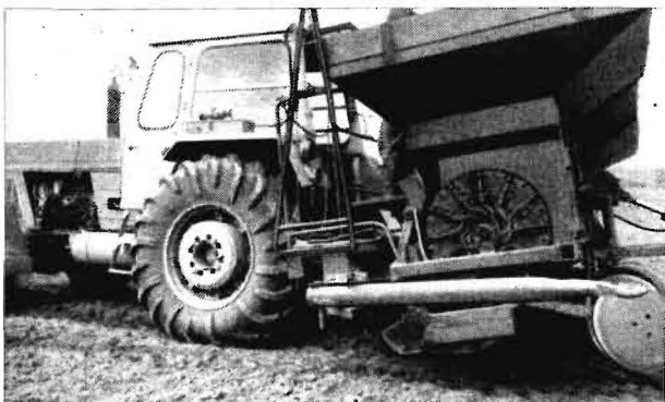
Bild 1. ZT 303 mit „Transvariant“-Versuchsreifen vor der 6reihigen Kartoffellegemaschine
