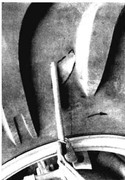
Bild 5 Der an der Reifenflanke anliegende Schenkel der Meßeinrichtung zeichnet die tangentielle Verformung des Reifens ab
