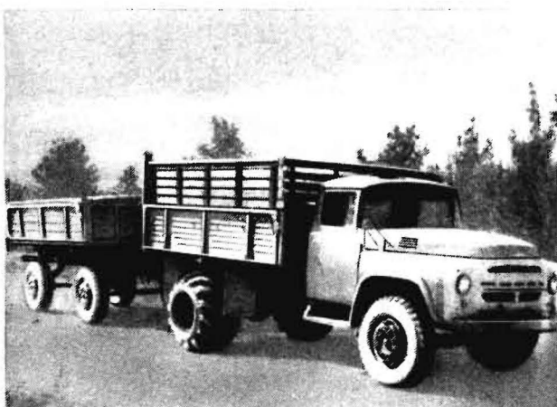
Bild 2. LKW SIL 130 in der Ausführung als Hinterkipper mit Anhänger, ausgerüstet mit Bogenreifen 1140 x 700 auf der Triebachse
