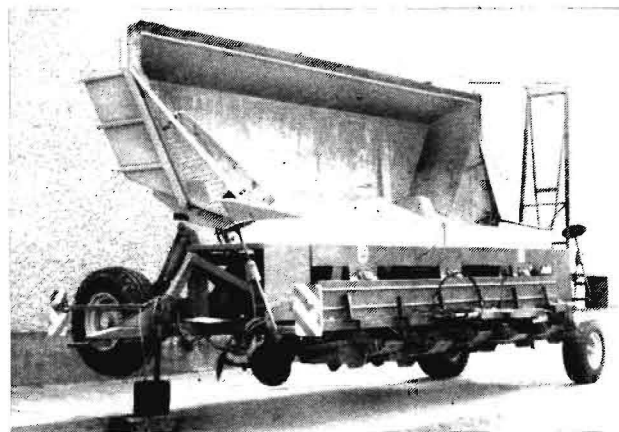
Bild 1. Vorderansicht der Kartoffellegemaschine 6-SaD-75 in Transportstellung
