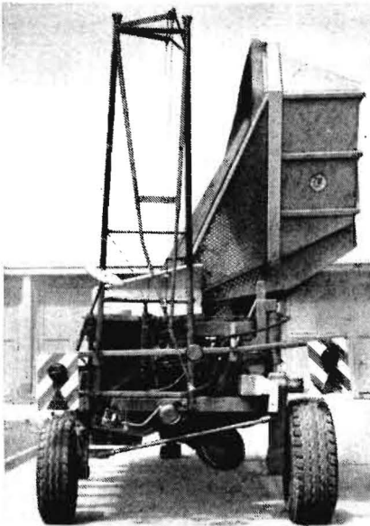
Bilder 3 und 4 Legemaschine 6-SaD-75 in Ar- beitsstellung ▼
