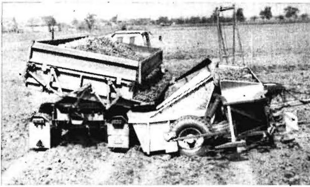
Bild 6. Direktbefüllung der Kartoffellegemaschine 6-SaD-75 vom Anhänger HW 80
