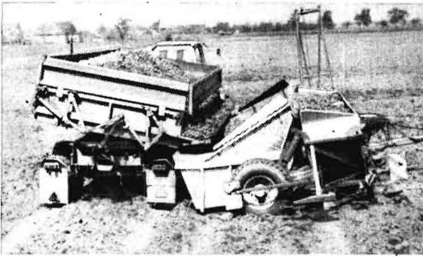
Bild 6. Direktbefüllung der Kartoffellegemaschine 6-SaD-75 vom Anhänger HW 80
