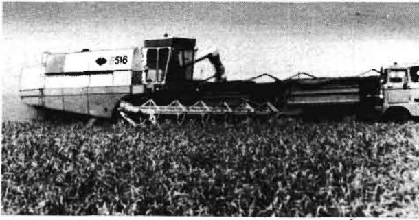
Bild 1. Mährescher E 516 beim Mähdrusch und bei der Getreideübergabe auf den LKW-Zug
