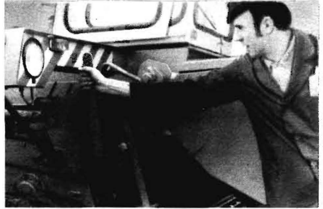
Bild 6 Angebauter Schwad- begrenzer des E247
