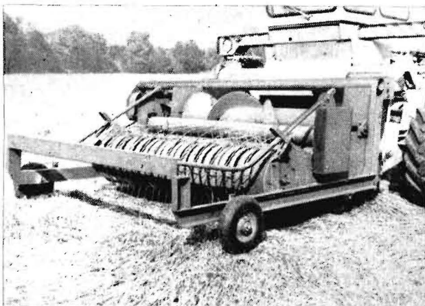
Bild 1. Abscheideaggregat am Schwadmäher E 307 im Feldversuch
