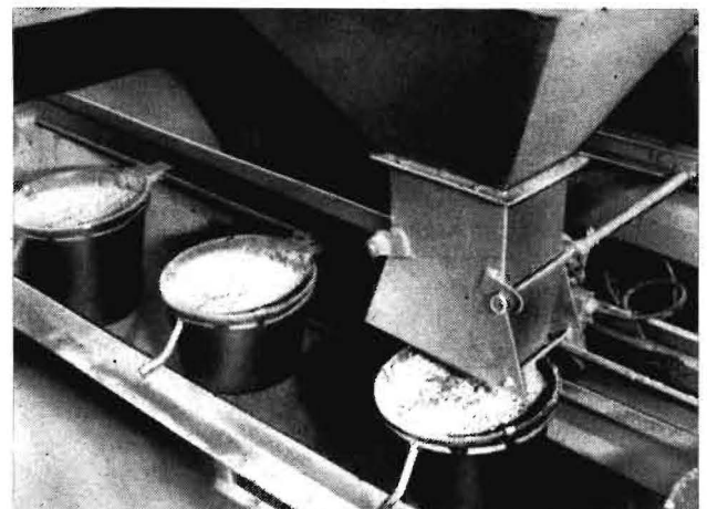
Bild 2. Übergabeeinrichtung des Kraftfutter-Trockengrünut-Dosierers
