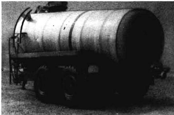
Bild 2. Anhänger mit Behälter Typ FKB 1/0 (GUP-Behälter mit Ringspannten)
