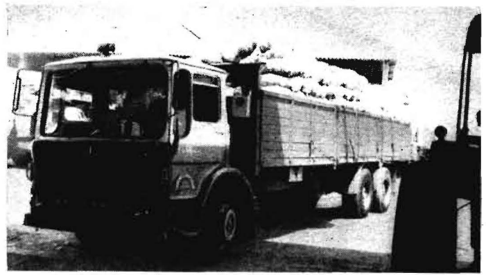
Bild 3 Kartoffeltransport von der Aufbereitungsanlage zum Kühllager in Säcken im großvolumigen LKW, Nutzmasse rd. 12 t
