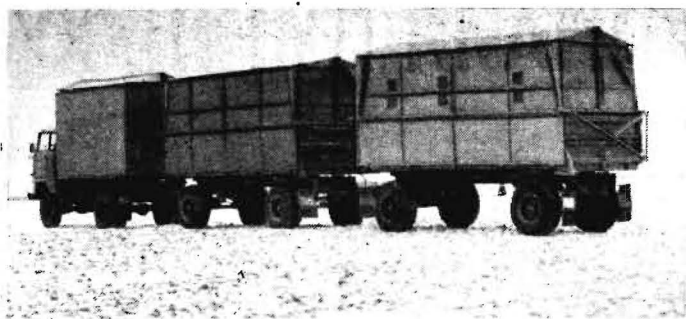
Bild 1 Transporteinheit für den Strohttransport vom Lager zur Pelletieranlage (Ladevolumen 76 m 3 , mit Laderaumabdeckung)
