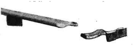
Bild 7. Rohlinge einer Kettenlasche von der Profilstange abgesichert
