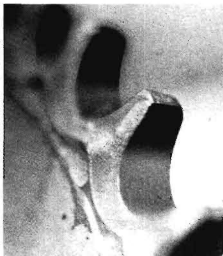
Bild 1. Abnutzung am Kettenrad durch Seitenverschleiß
