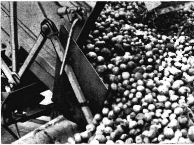
Bild 3. Leitblech für den Anhänger HW 60.11
