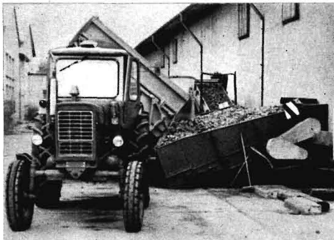
Bild 1. Vom Anhänger HW 60.11 werden die Kartoffeln in den Annahmeförderer „Arensdorf“ entladen
