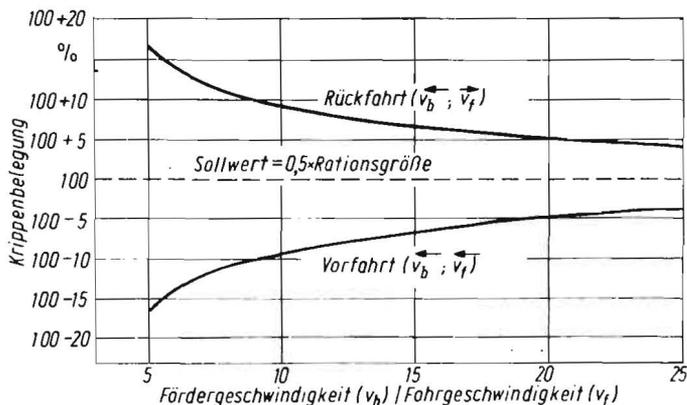
Bild 4. Unterschiedliche Krippenbelegung bei Vor- und Rückfahrt für Gurtbandförderer, längsverfahrbar
