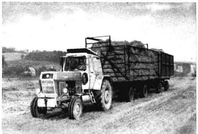
Bild 2. Transporteinheit ZT 300 und 2 THK 5 mit speziellem Strohaufbau
