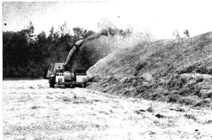
Bild 6. Mobiles Strohgebläse MSG 900 bei der Einlagerung von Ballenstroh
