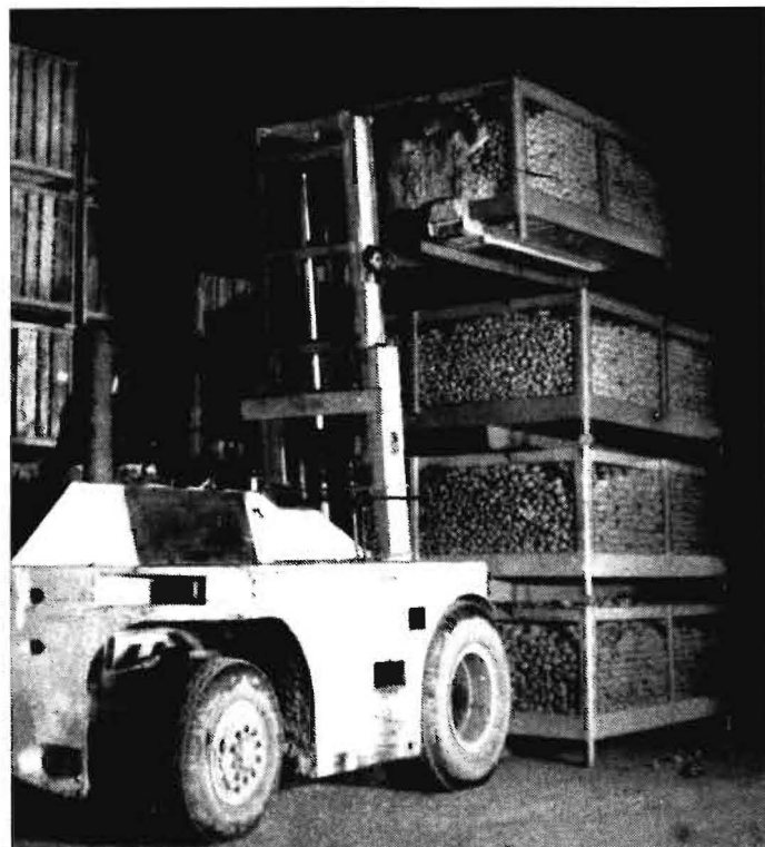
Bild 2. Behälter T 922-C (Volumen 4,8 m 3 ) bei der Befüllung auf dem Feld
