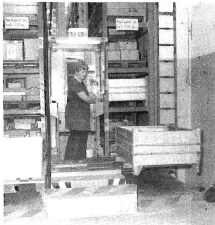
Bild 2. Bediengerät an der Übergabestelle mit aufgesetzter Palette
