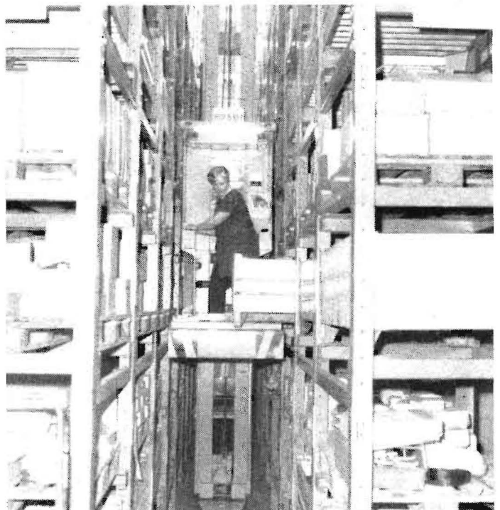
Bild 3. Bediengerät bei der Übernahme einer Palette aus dem Regal
