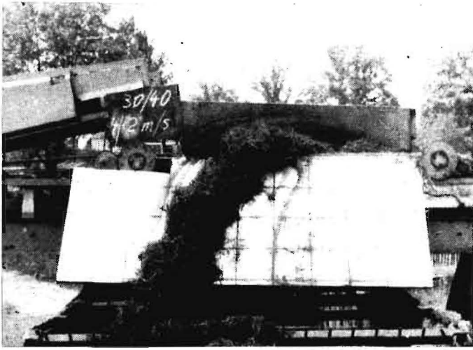
Bild 4 Gutstrom auf der Schurre ( v = 2 \text{ m/s} ; \beta = 30^\circ ; \alpha = 40^\circ ) bei einem Durchsatz von 25 \text{ t/h}
