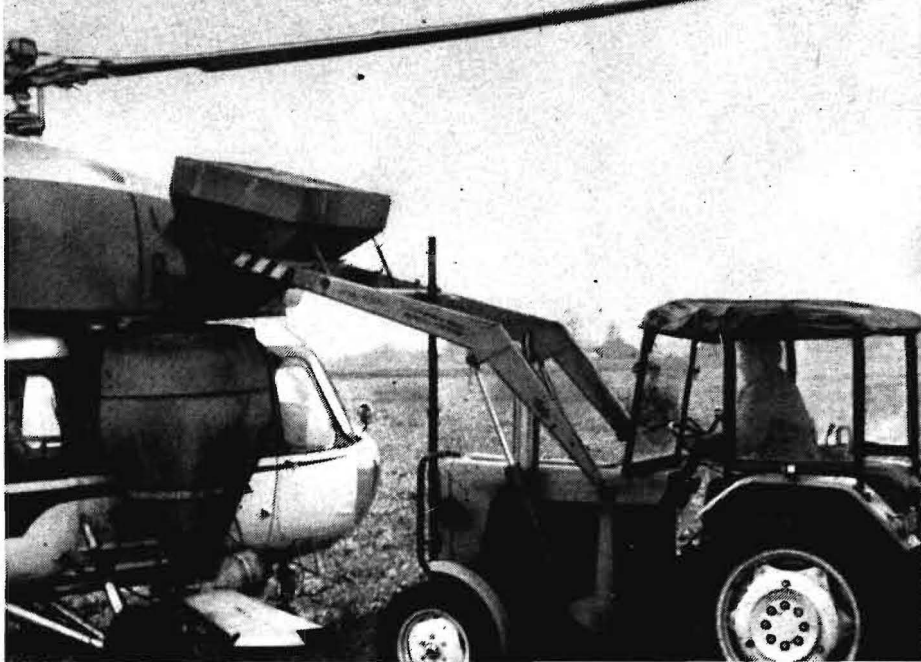
Bild 1. Der zur Beladung des Hubschraubers umgerüstete Traktorfrontlader T 210 „Tur“
