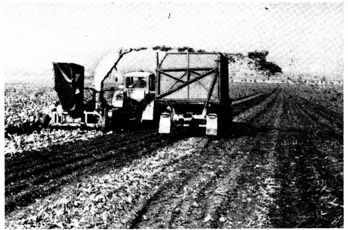
Bild 8. Überblasverluste, eine Verlustquelle, die nicht nur beim Rübenblattköpfen, sondern besonders auch bei der Futterernte häufig auftritt
