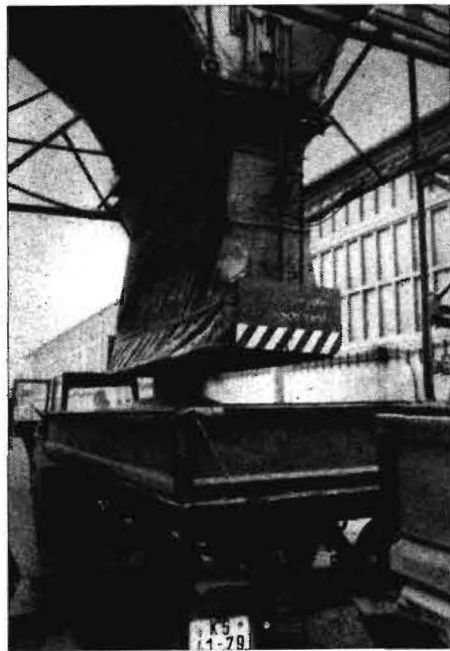
Bild 2. Fahrzeugbeladung bei herabgelassenem Staubsack
