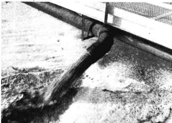
Bild 4. Homogenisierung durch Umpumpen
