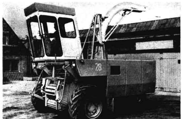
Bild 3. Exportausführung des Traktors ZT 300 für die VR Angola mit Frontschiebeeinrichtung
