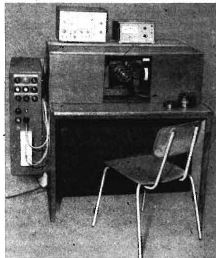
Das Wälzlagerprüfgerät wird in der Originalausführung [4] eingesetzt. Als Bewertungskriterium des Laufbahnzustands dient die Amplitude eines Frequenzbands von 10 kHz.
