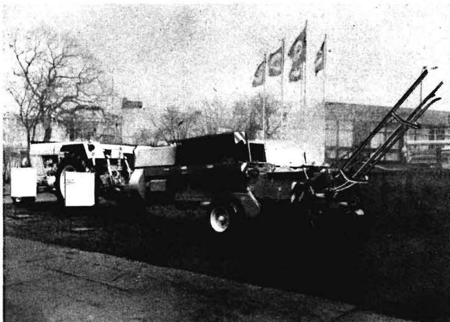
Bild 2. Hochdruckpresse K 454 für Anhängerverfahren (Fotos: K. Müller)
