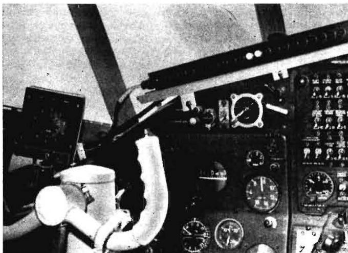
Bild 5. Dekameter (links) und Anzeigerät für die Anzahl der Durchflüge an Bord des Flugzeugs AN-2 R
