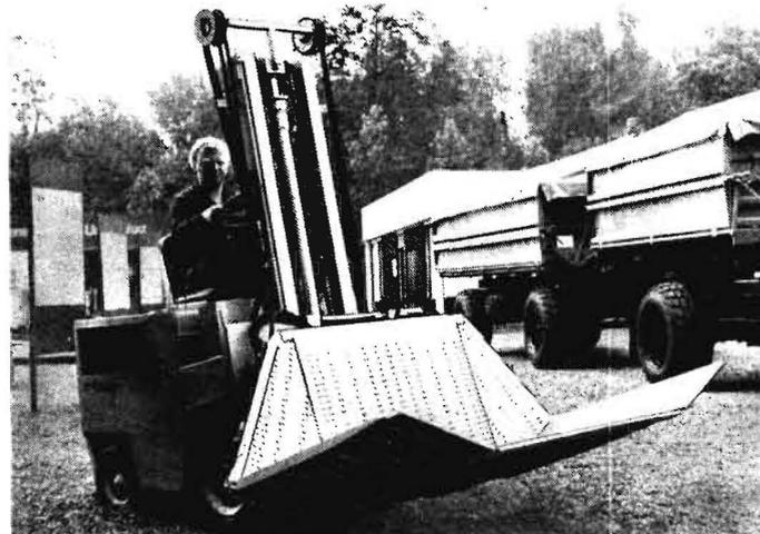
Bild 6. Gabelstapler mit Spezialschaufel, deren Seitenwände abklappbar sind (LPG Börde-Gemüse Magdeburg) (Foto: G. Schmidt)
