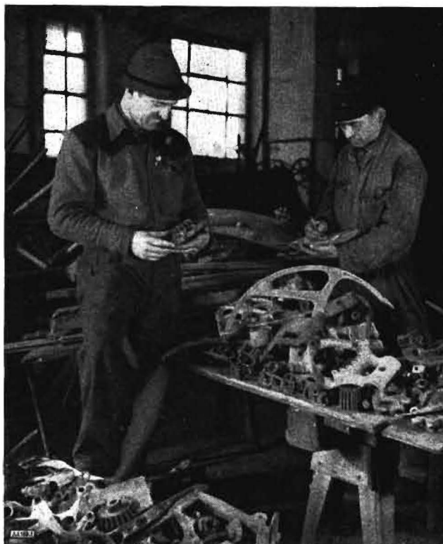
Bild 1 Aus schrottreifen Landmaschinen und Geräten wurden viele noch brauchbare Maschinenteile gewonnen, die den Reparaturwerkstätten der MAS nach entsprechender Verarbeitung als Ersatzteile zur Verfügung stehen
