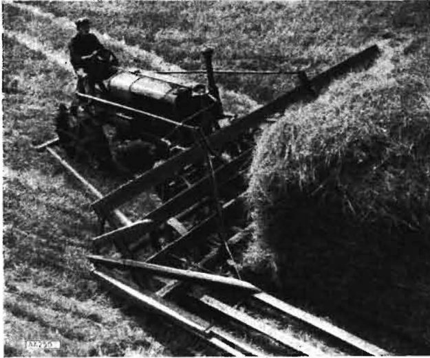
Bild 4 Die Akimower wissenschaftliche Forschungsstelle für Mechanisierung der Landwirtschaft konstruierte diese Traktorenrechenmaschine. Sie dient dem Transport von Stroh und Heu zum Schober. Der gesamte Mechanismus wird vom Traktorenführer bedient
