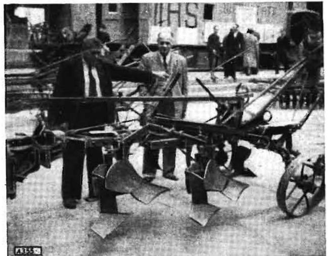
Bild 9 Ein- und Ausrückvorrichtung für Untergrundscharre.
