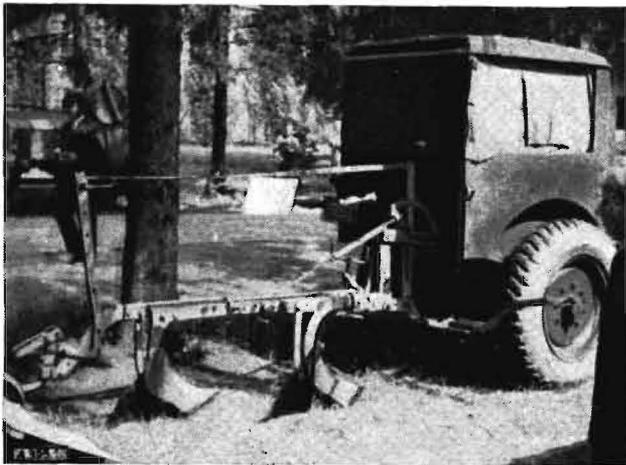
**Bild 13** Anbaupflug mit Hinterrad und von Hand zu betätigender Aushebung
