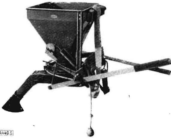
Bild 5 Ein neuartiges Rückentragestäubegerät
