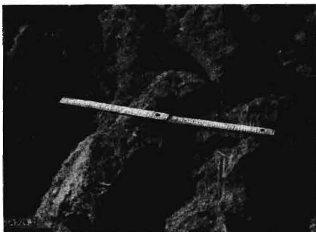
Bild 2 Zementharte Schollen zeigen keine Neigung zum Zerfall
