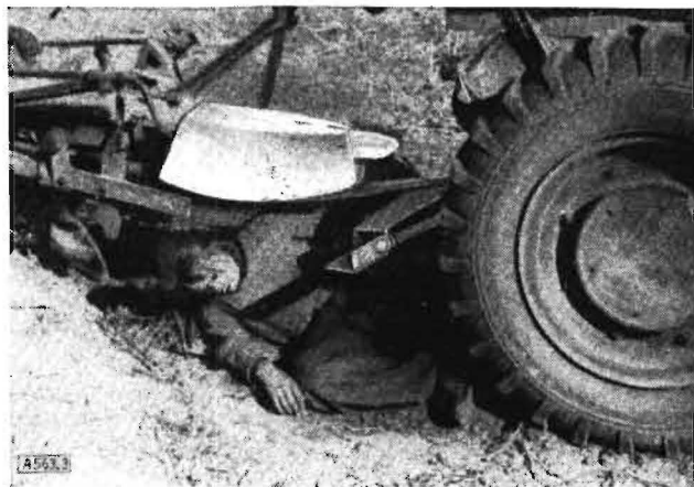
Bild 3 Der Fahrer stieß an die ungeschützte Zapfwelle
