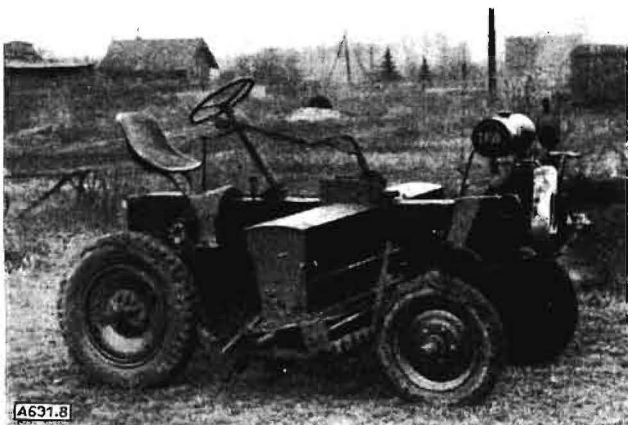
Bild 8 Maulwurf mit eingebauter Drillmaschine
