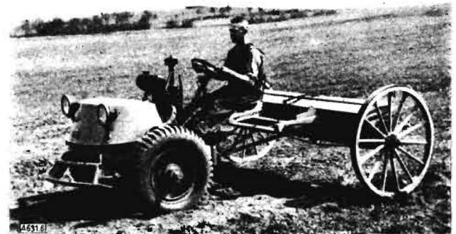
Bild 6 Vorsatzgerät mit Drillmaschine Fünfstreife
