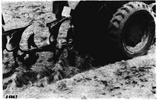
Bild 7 „Trabant“-Pflug arbeitet als freischwingernder Drehpflug
