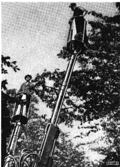
Bild 5. Der Obstpflücker, in hohe Bäume eingeschoben
