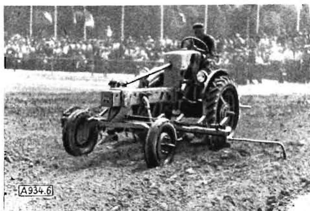
Bild 6. IFA-Schlepper RS 15 mit Anbaugeräten im Einsatz
