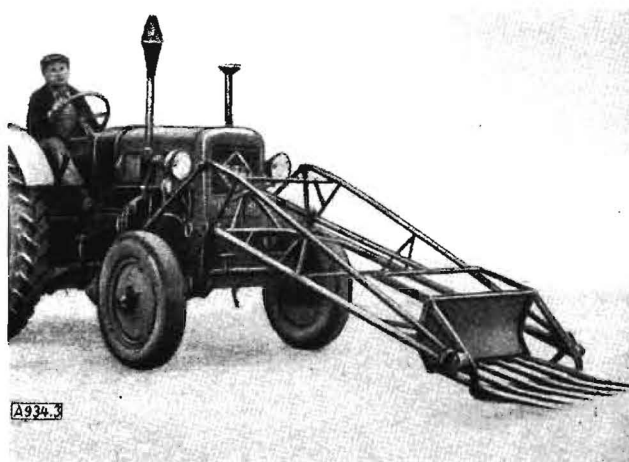
Bild 3. Hublader für Stallmist, Heu, Stroh u. dgl.
