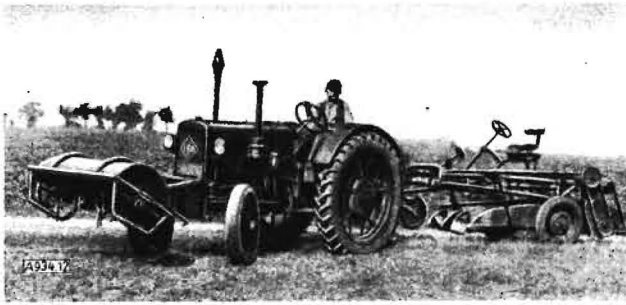
Bild 12. Anbau-Kartoffelvorratsroder, kombiniert mit Krautschläger
