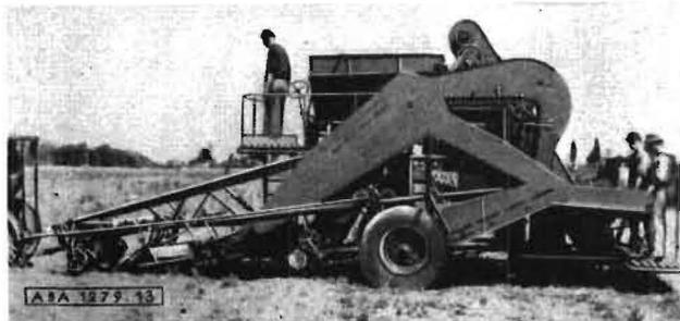
Bild 1. Schatzgräber — Vollerntemaschine 2002
