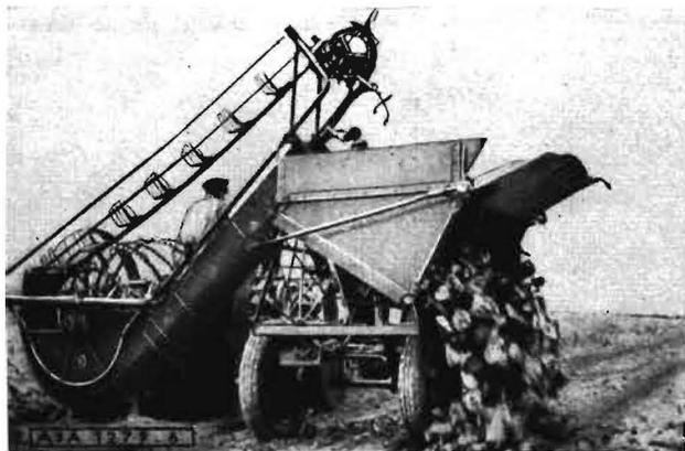
Bild 6. Rübenrodemaschine Sack mit Bunker
