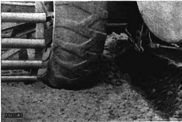
Bild 5. Bei trockenem Boden kommt das Gitterrad kaum zum Tragen. (Beachte bitte die wesentlich tiefere Spur des Vorderrades auf der rechten Bildseite).
