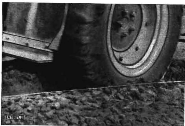
Bild 2. ... während dasselbe Rad auf nassem Boden bis auf die Furchensohle abrutscht
