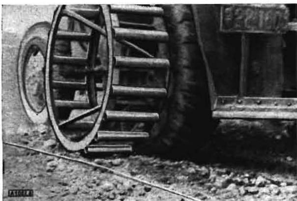
Bild 6. Begrenzte Einsinktiefe des Luftrades durch die verbreiterte Auflage des Gitterrades
