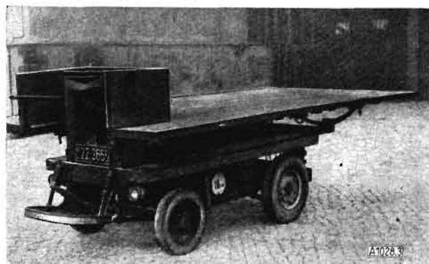
Bild 3. Elektrokarren mit vergrößerter Ladefläche
