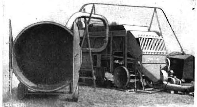
Bild 1. Dreschhäckseln: NEMA-Gebläsehäckslers mit NEMA-Spreu- und Häckselwagen hinter NEMA-Dreschmaschine
