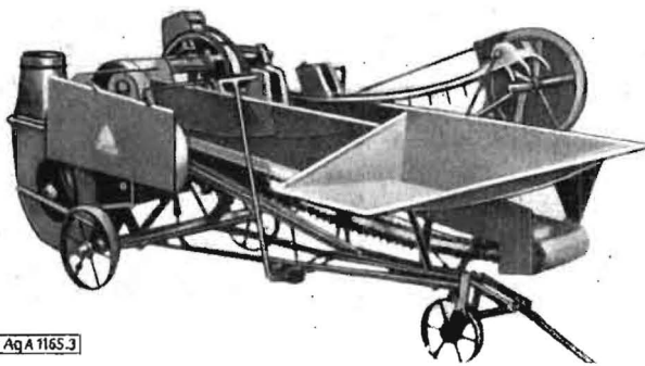
Bild 3. Gebläsehäckler mit Selbsteinleger und abgewinkelter Einlegemulde
