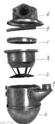
Bild 1 und 2. Wirbelluftfilter. a Topf, b Prallteller, c Patrone, d obere Haube, e Patrone, f Verschluss, g Filzring, h Einsatz
