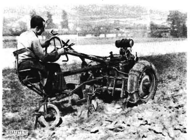
Bild 11. Versuche mit Wechsellpflug, im Moment des Einfahrens in die Furche
