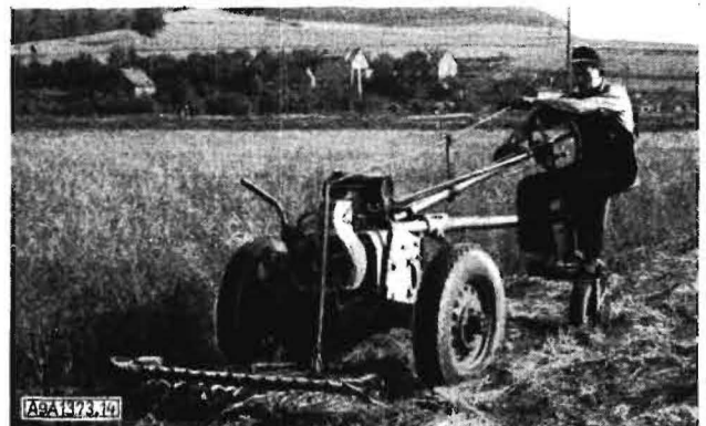
Bild 14. Spornrad läuft z. B. in der Spur des linken Triebbrades
