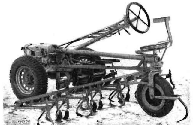
Bild 21. Gartenschlepper mit noch zu weit hinten liegenden Hackebeln
