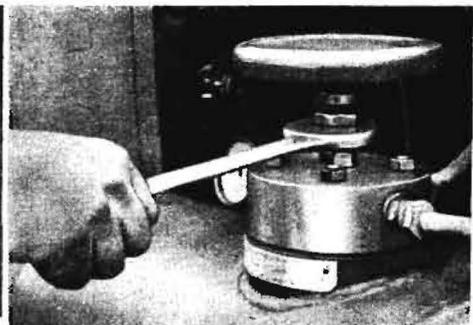
**Bild 14.** Bläst beim Öffnen des Hauptventils an der Spindel Luft heraus, so muß die Dichtpackung durch Nachziehen der großen Überwurfmutter wieder dichtfähig gemacht werden
