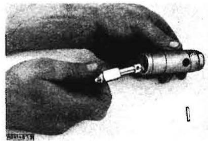
**Bild 9.** Ist der Haltestift entfernt, läßt sich der Ventilkegel ohne weiteres herausziehen. Die Ventillfeder bleibt dabei noch im Ventilgehäuse. Soll sie auch entfernt werden, müssen erst zwei weitere Haltestifte mittels Dorn in das Gehäuseinnere geschlagen werden
