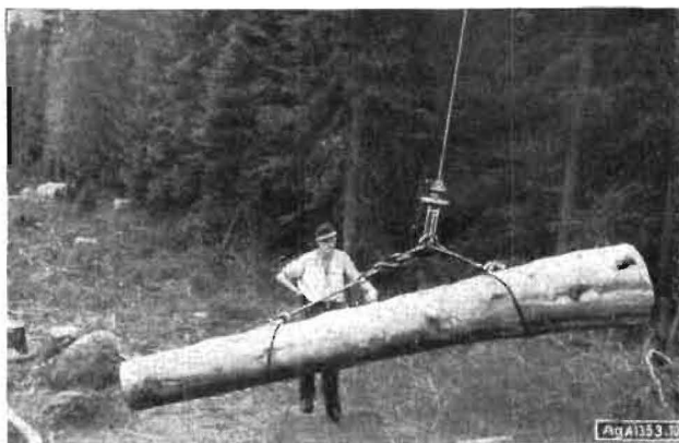
Bild 14. Wyzsen-Seilkran beim Aufnehmen der Last
