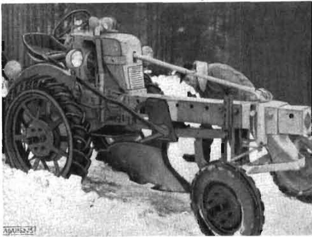
Bild 19. Geräteträger „Maulwurf“ mit untergebaute Waldpflug
