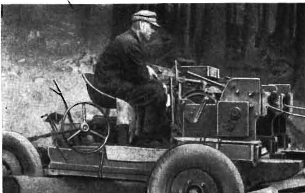
Bild 12. Rückewinde Scheuch (Versuchsmodell) bei der Arbeit
