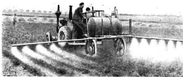
Bild 3. CL-Gespansspritze, für Schlepperzug umgebaut
