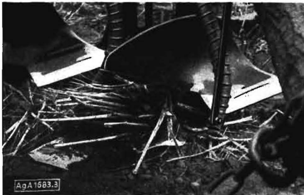
Bild 3. Verstopfungen zwischen Pflugkörper und Wühlschar
