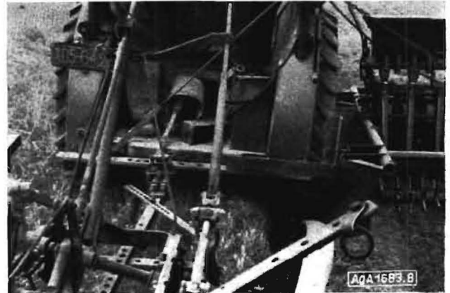
Bild 8. Um den Seitendruck des Gerätes aufzuheben, wird der Pflug weiter nach links gehängt
